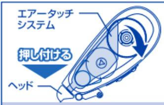
ヘッドを紙面から離すとテープの供給がロックされる仕組み。修正テープを切るために必要だった抵抗の大軒に成功!!
